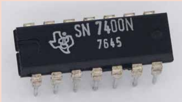
Vier NAND-Gatter mit jeweils zwei Eingängen in einem Gehäuse (Foto: Stefan506, Lizenz: CC BY-SA 3.0)
